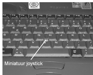
Figuur 1.2: Geminiaturiseerde joystick voor draagbare toepassingen.
