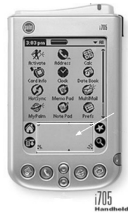
(a) Mini-digitaliseertablet ingebouwd in een PDA van Palm [3].
