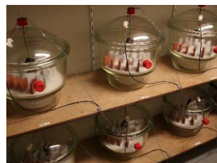
h) Desiccator test
