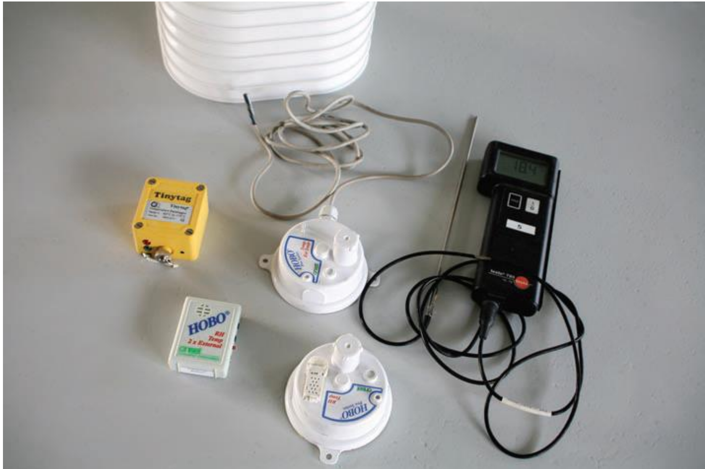
Verschillende vocht- en temperatuurmeters - WTCB jaarverslag 2008
