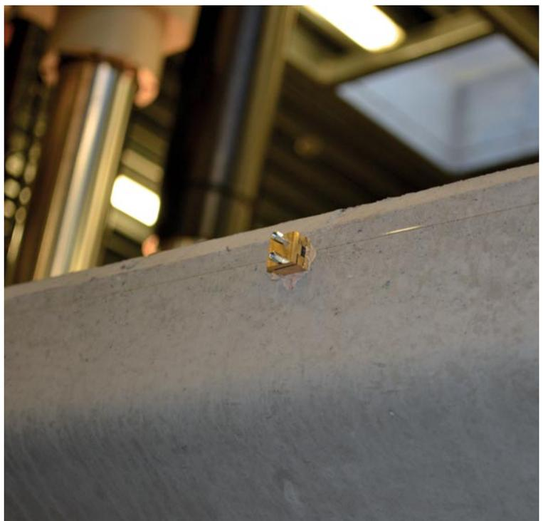
(d) Mechanically anchored optical fibre
