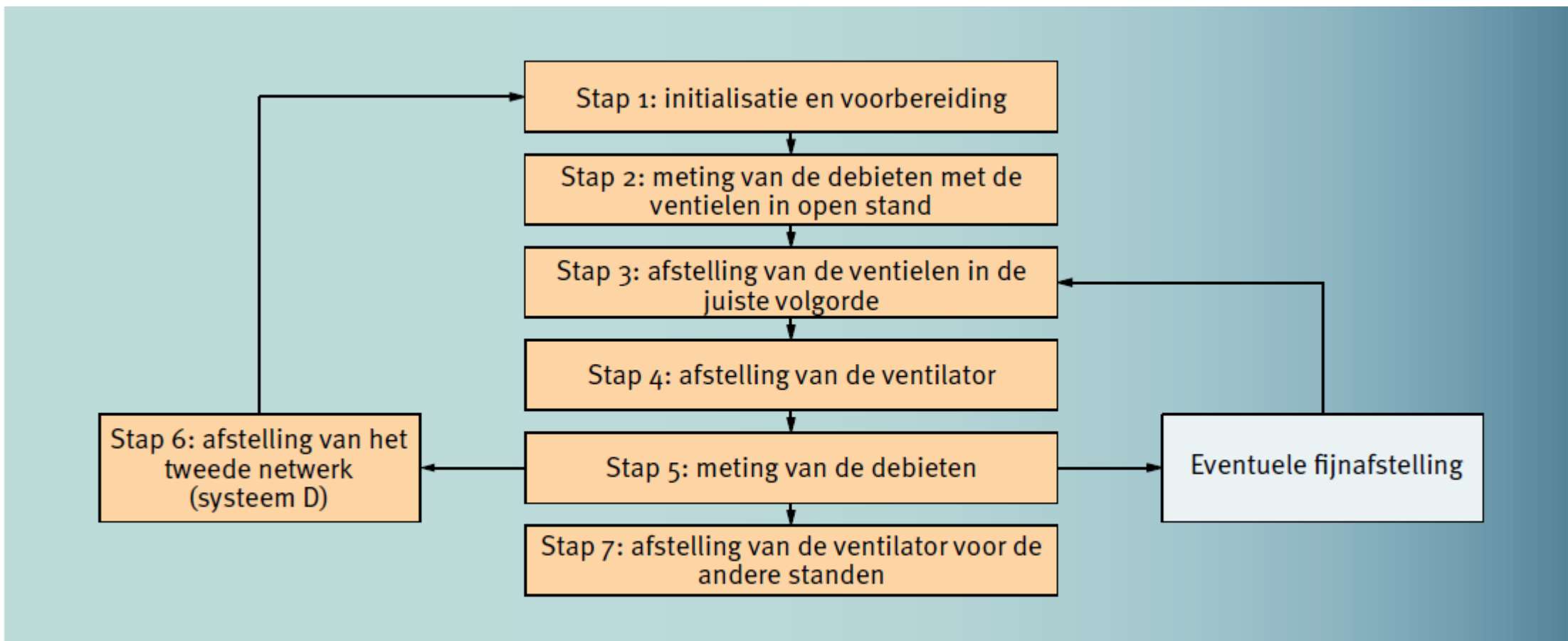
Afb. 92 Opeenvolgende stappen van de vereenvoudigde afstemmethode.
