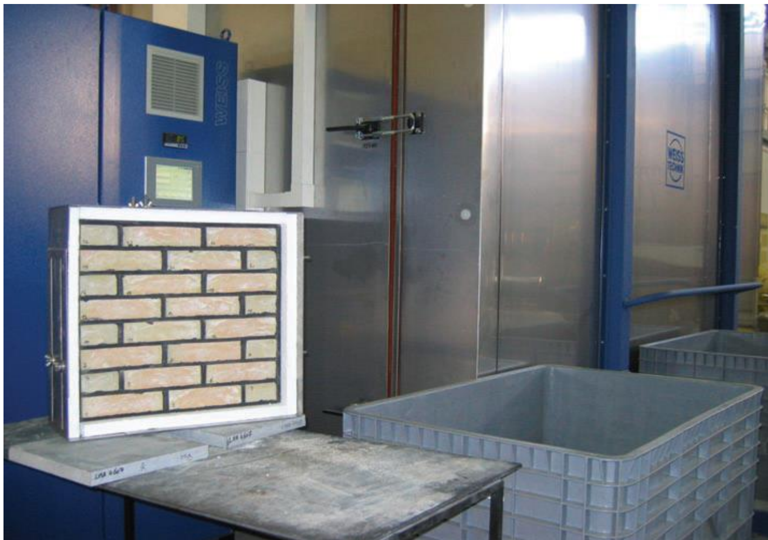
Proefstuk en proefstand ter bepaling vochtbestendigheid metselwerk - WTCB jaarverslag 2007
