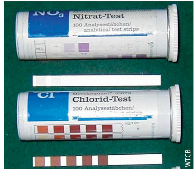
Afb. 41 Indicatiestrookjes waarmee men de aanwezigheid van zouten (nitraten en chloriden) kan vaststellen.
