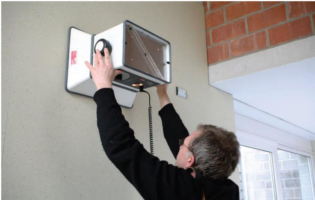
Meting luchtdebieten mechanische ventilatie - WTTCB jaarverslag 2008
