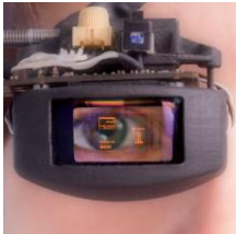
Fraunhofer prototype \mu display 320x240 px
