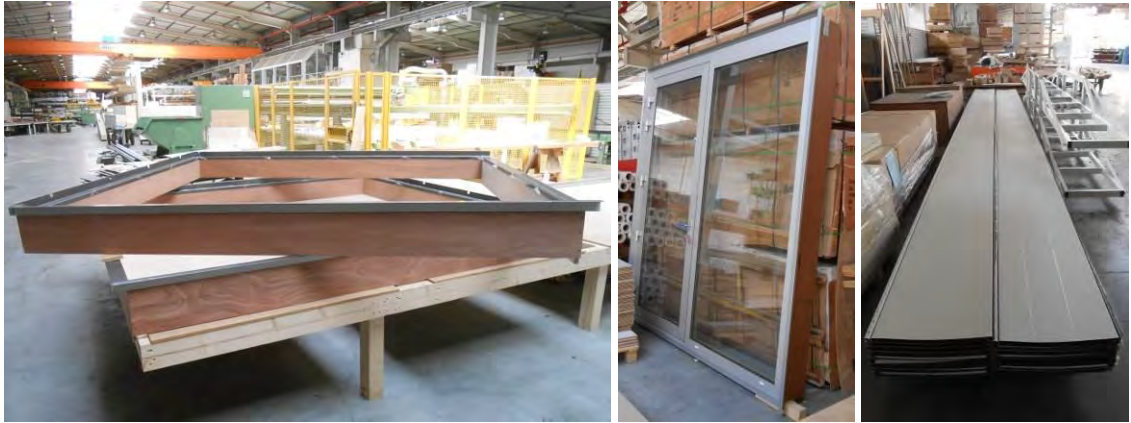
Figuur 3.40: (links) raamkaders zonder vulling en (midden) een met vulling. (Rechts) felsplaten voor de dakbedekking. (Hahbo, 2014)
