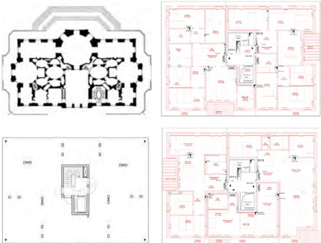
Figuur 3.17: De idee van 'enfilade' van ruimten uit de barokke bouwperiode werden toegepast op de plannen van Grundbau und Siedler tijdens voorontwerpfase (rechtsboven). Rechtsonder een voorbeeldplan van de uiteindelijke plannen waarbij meer gebruik gemaakt werd van open ruimtes © BeL Sozietät für Architektur
