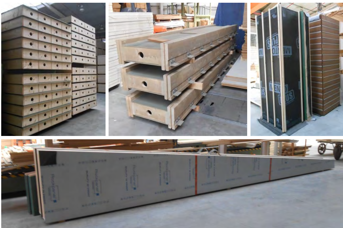
Figuur 3.39: (linksboven) links op de foto dakpanelen en rechts vloerpanelen. (Midden boven) leidingschachten. (Rechtsboven) hoekpanelen, waarvan een al is afgewerkt met gevelbekleding. (Onder) tipgevelelement voor de kopgevels. (Hahbo, 2014)
