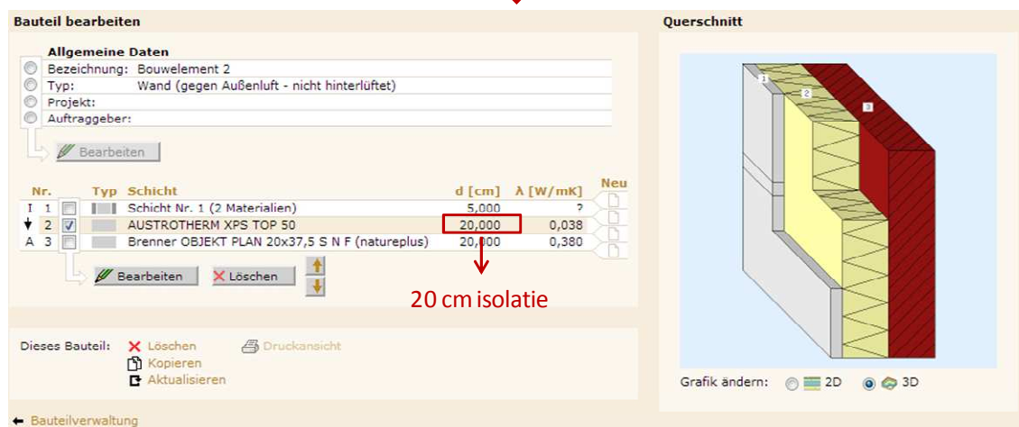
Figuur 32: Grafische weergave van een buitenwand in Baubook. De weergave past zich aan de invoergegevens aan (IBO 2013).
