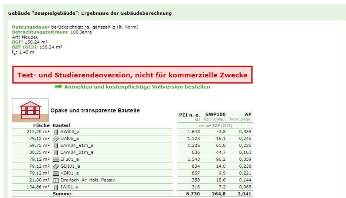
Figuur 15: Vereenvoudigde gebouwberekening op basis van de som van de milieu-impact van de ruimtebegrenzende gebouwelementen, vermenigvuldigd met hun respectievelijke ratio binnen het gebouw - Baubook eco2soft (IBO 2013).
